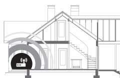
Posición no adecuada del enrutador
