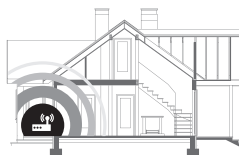
Positionnement inadéquat du routeur
