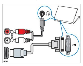
Câble HDMI et adaptateur HDMI-DVI (arrière HDMI et AUDIO IN)
