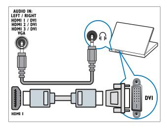
Câble HDMI et adaptateur HDMI-DVI (côté HDMI et AUDIO IN L/R)
