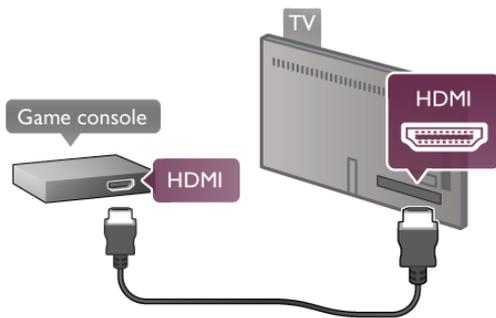
Pour une qualité optimale, utilisez un câble HDMI pour brancher la console de jeux sur le côté du téléviseur. Si la console de jeux est connectée via HDMI et est dotée d'EasyLink HDMI CEC, vous pouvez la commander à l'aide de la télécommande du téléviseur.
