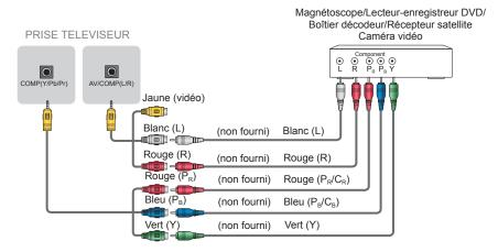
AV Connectez un câble composite d'une source A/V externe.
